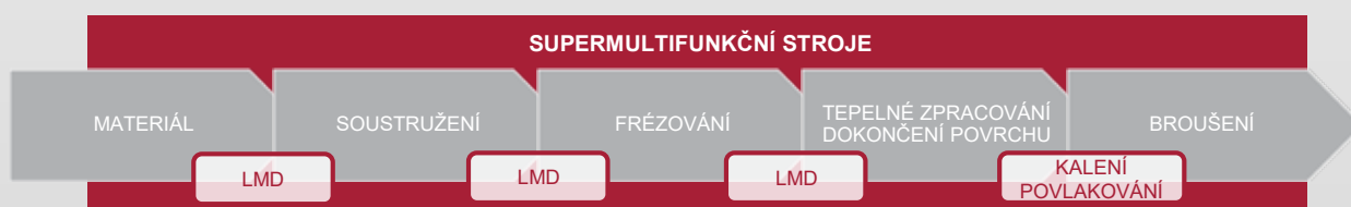
Schéma porovnání konvenčních a LASER EX strojů
