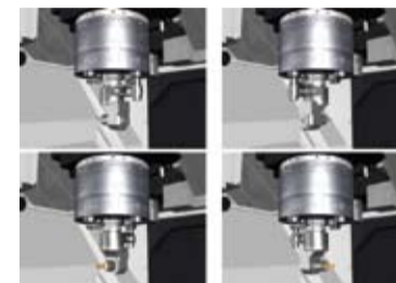
Unikátní systém indexace výměnných nástrojů po 90°
